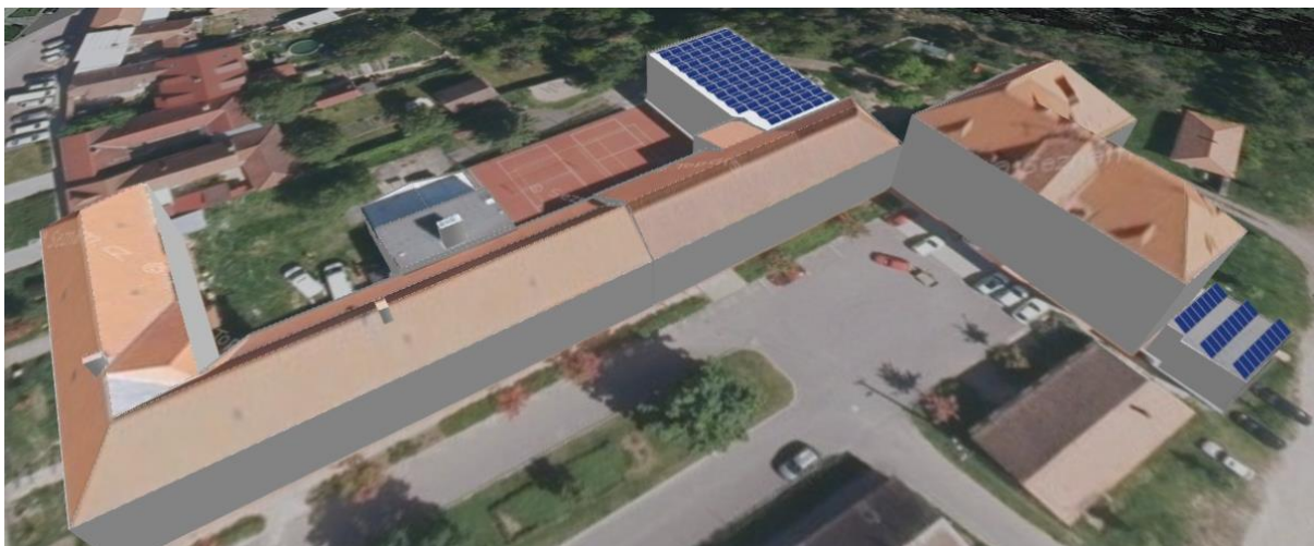
Obrázek 18 Umístění fotovoltaických panelů na plochých střechách areálu. FVE o špičkovém výkonu 66,9 kWp
