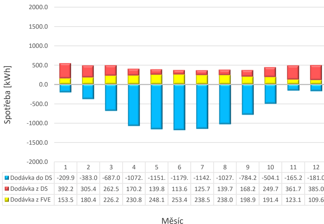
Obrázek 9 Simulace FVE 9,9kWp s bateriovým uložištěm 12kWh
