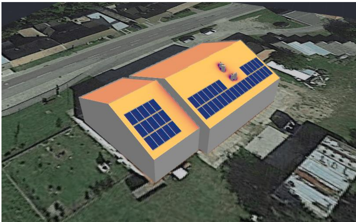
Obrázek 21 Navržená FVE 19,9 kWp na budově hasičky č.p. 417.
